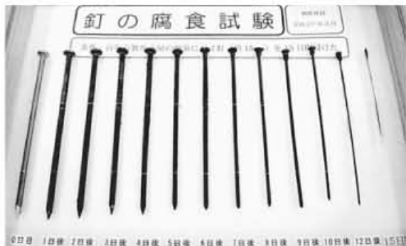
釘の腐食試験 実験の結果。左はしの0日目から右はしの15日後へと、白にちがたつにつれて、くぎが細くなっていく＝品木ダム品質管理所で
