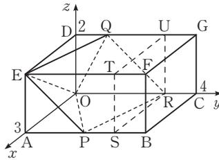
ここで、点 R を通る平面  $y = 3$  と辺 AB, EF, DG の交点をそれぞれ S, T, U とおくと、対称性より、平面 EPQ (平行四辺形 EPRQ) によって直方体 OASR - DETU は合同な二つの六面体に分けられる。このうち、原点 O を含む六面体から四面体 DOEQ と四面体 AOEP を除いた図形が四角錐 O - EPRQ であり、その体積を  $V$  とおくと
