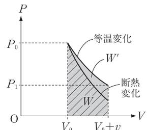
◀ 断熱変化の場合、気体の体積が増加すると、外部にした仕事の分だけ内部エネルギーが減少して温度が下がる。
