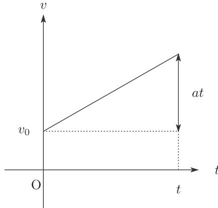
(2) 微小時間  $\Delta t$  での変位  $\Delta x = v \cdot \Delta t$  を合計すると、(1) の  $v-t$  グラフと  $t$  軸の間の面積となるので、
