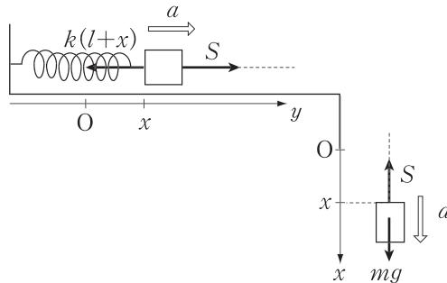
糸の張力の大きさを  $S$ ,  $y$  軸の正の向きに加速度  $a$  を設定すると, A, B の  $y$  軸,  $x$  軸方向の運動方程式は
