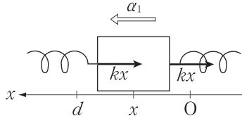
$M$  が位置  $x$  を通過するときの加速度を  $\alpha_1$  とすると、 $x$  軸方向の運動方程式は
