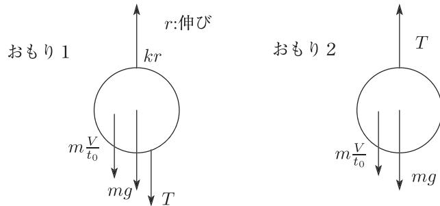
時刻 0 以前のおもり 1 の静止位置を原点とする、エレベーターに固定した鉛直上向き正の座標軸を設定する。このときのおもり 1, 2 の運動方程式はそれぞれ、
