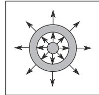
(d) 導線を通して電子が流入し C の外面の電荷が 0 となる. このとき, C の外部では電界が 0 となるので, A には電気力が作用しない. よって, 糸の角度は 0 となる.
