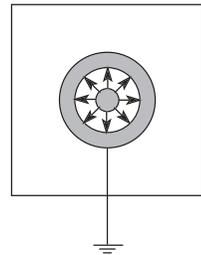
(e) 導線を切り離しても電気量の分布は変わらない. このため, C の外部の電界は 0 のままで, A には電気力が作用しない. よって, 糸の角度は 0 のままとなる.
