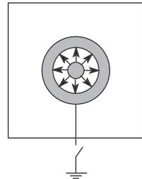
(f) C と B をつなぐと, B の電荷はすべて C の外面に移動する. このとき, C の外部には (a) と同じ電界 (c) を生じているので, A には (b) のときと同じ電気力が作用する. よって, 糸の角度は  $\theta$  にもどる.
