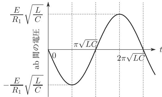
(2)  $i_3' = 0$  の瞬間、 $V_{ab}' = \pm \frac{E}{R_1} \sqrt{\frac{L}{C}}$  より、C に蓄えられる電荷を  $Q_0$  とすると、
